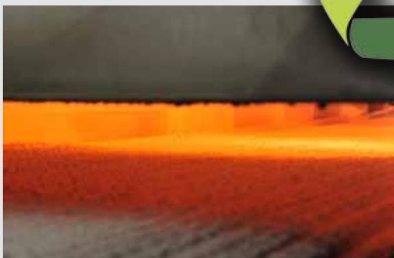
Bei ca. 900° wird Glasmehl zu Glasscham aufgebläht. Fotos: © GEOCELL®
