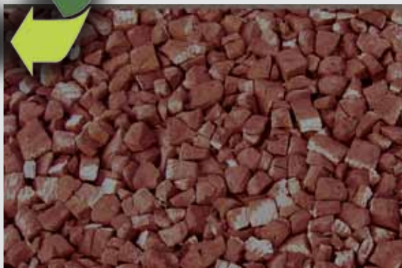
Beim Abkühlen bricht der Kuchen durch Spannungsrisse zu Schaumglasschotter.
